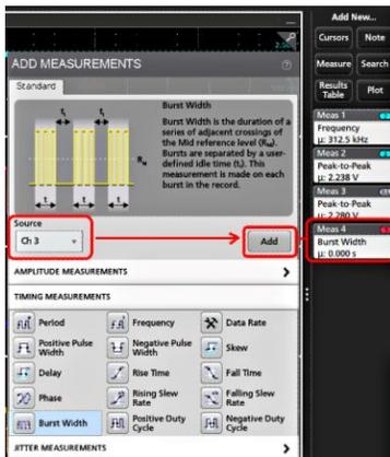
8. Чтобы закрыть меню **Add Measurements** (Добавить измерения), коснитесь экрана за пределами меню.
